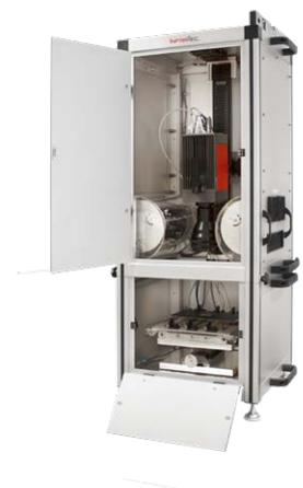
Kontaktlose und kontaktierte Anregung in Messzelle (LimoLIT/VomoLIT)
